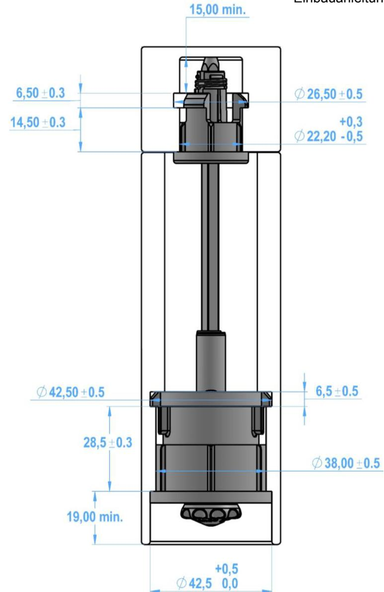
Bitte kontaktieren Sie uns für 3D-Dateien dieses Mechanismus. Alle angegebenen Maße sind in mm. Die angegebenen Toleranzen sind zum Einbau in Holzprodukte. Es werden mindestens 6mm Wanddicke um die Rippen für hölzerne Produkte empfohlen.
